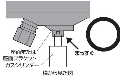
②座面に座り、体重をかけて押し込んでから、高さ調節をします。
